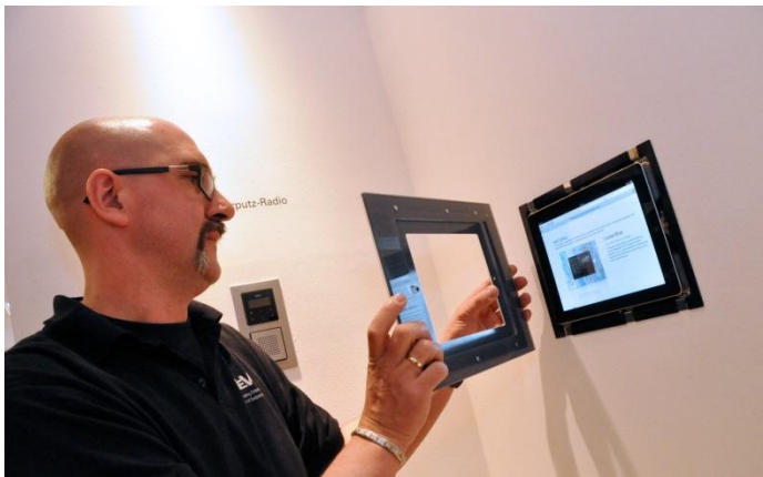
Bernhard Herter lüftet das Geheimnis hinter der designten Abdeckplatte: ein Einbaurahmen mit einer Einbautiefe von nur 45 mm. In der zusätzlichen Variante für öffentliche Gebäude lässt sich die Glasabdeckung nicht mehr entfernen.
